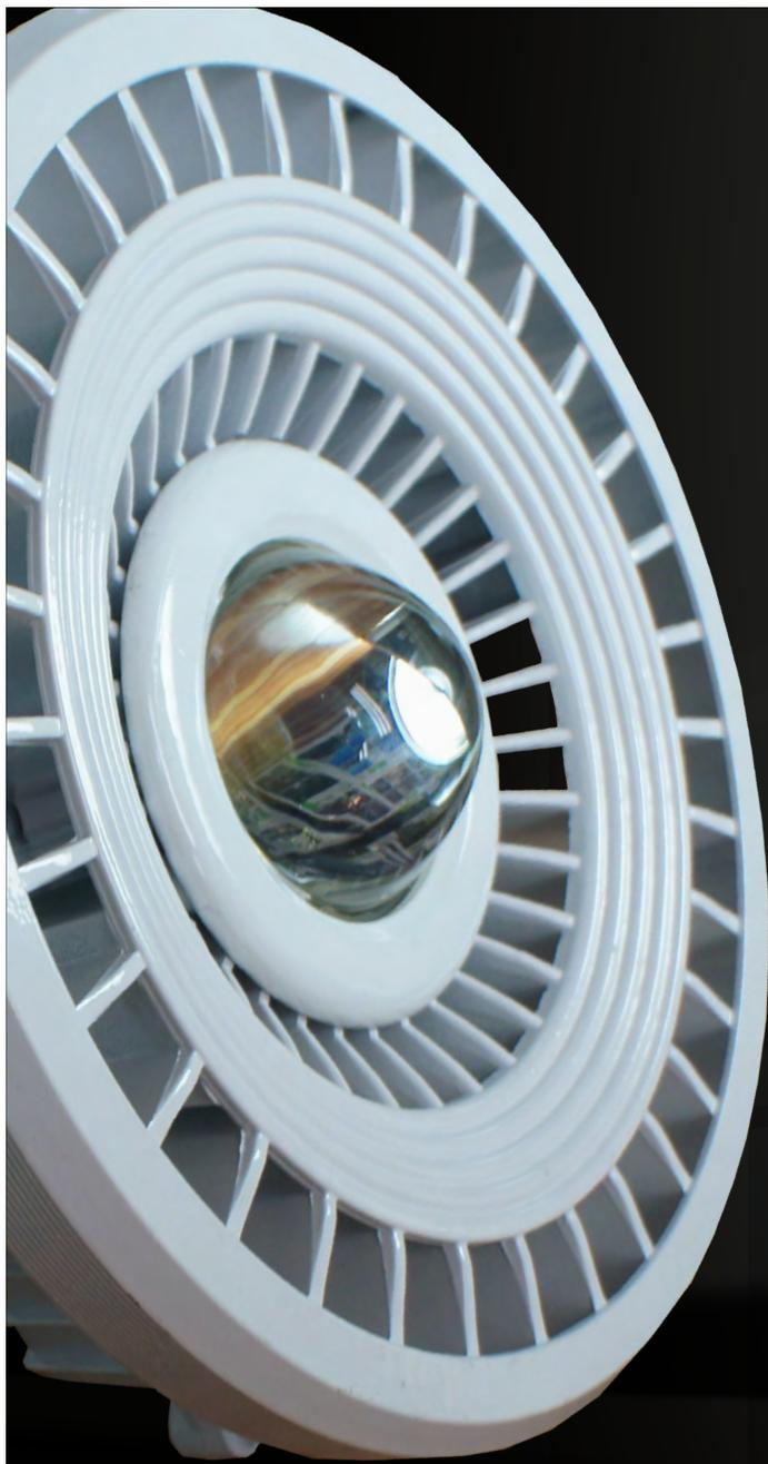
DOME(ドーム)シリーズは、工場や体育館などの高天井施設、駐車場外灯などに最適なLED照明です。100V～200Vの直接入力可能な内蔵式で設置が簡単。IP67の防塵・防水仕様で屋外でも使用できます。出力は60W～400Wまでの5タイプ、使用する場所や用途に合わせて幅広く対応できます。水銀灯は点灯後、所定の明るさになるまで10分程度が掛かりますが、LEDは電圧に対する反応が早く、点灯後約1秒で最大の明るさに達します。瞬時点灯・再点灯が可能で、休憩時間などにこまめな消灯ができ、節電に効果的です。食品工場などでは大敵な虫も来ません。長時間照明を点灯している場所や、たくさんの照明器具を設置している場所をLEDに替えば、電気代・メンテナンスコストの大幅な削減を期待できます。また、電気代と共にCO2排出量も大幅に削減でき、水銀などの環境有害物質を使用していない為、環境にも優しく様々な施設に導入され始めています。
