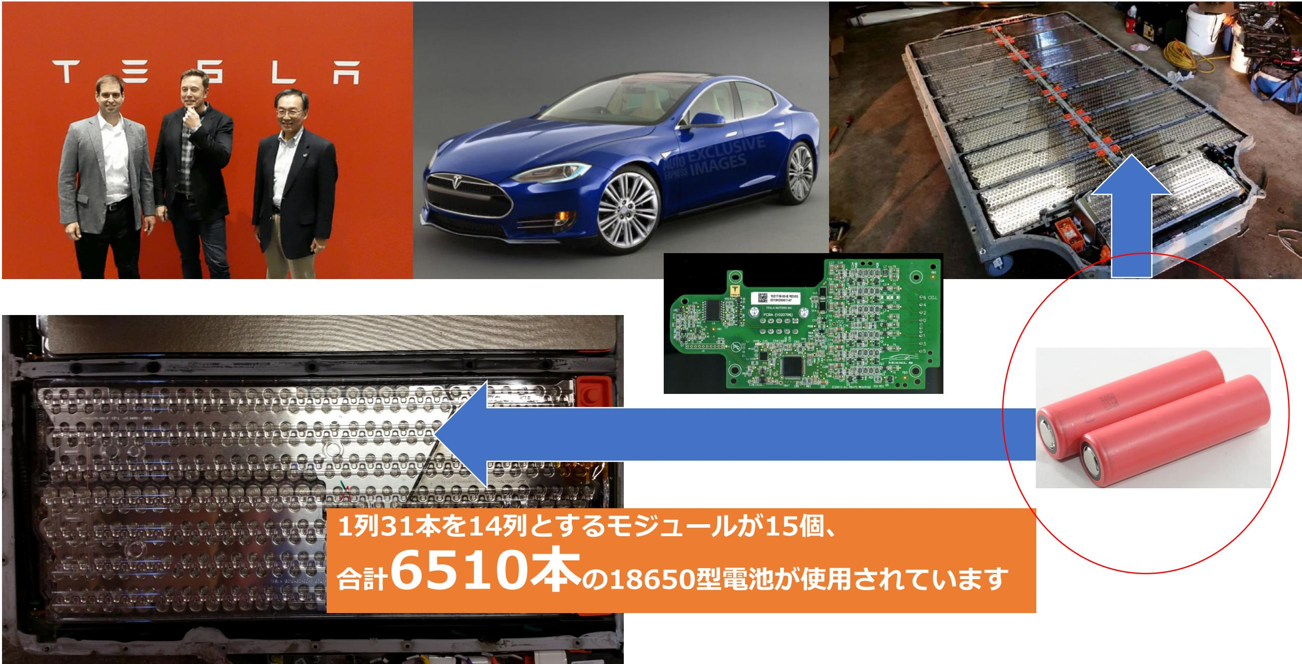
テスラモデルSには、[パナソニック製18650型リチウムイオンバッテリー](#)が数千個積まれており、最大で85Kwhという大容量を実現しています。リチウムイオン電池は、単3乾電池を一回り大きくしたような形状です。
